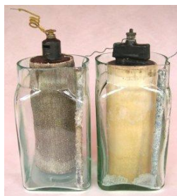
Piles à deux bains de Leclanché, dites piles à sac, ou à grand débit, utilisées par les PTT au début XXe
