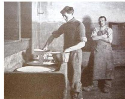
**Dans les premières laiteries, l'écrémage se faisait à la main. Les rondots étaient rafraîchis à l'eau courante dans des bacs.**
