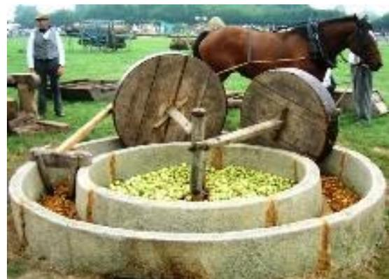
**Le tour à piler était une auge circulaire portant en son centre un pivot où était fixée une barre d'attelage de manège engagée au milieu d'une meule verticale. Celle-ci, en bois ou en granit, entraînée par la marche du cheval et roulant dans l'auge circulaire, écrasait (ou pilait) sur son passage les pommes qu'on y avait jetées. D'où le nom de « pilous » donnés à ceux qui effectuaient la tâche.**
