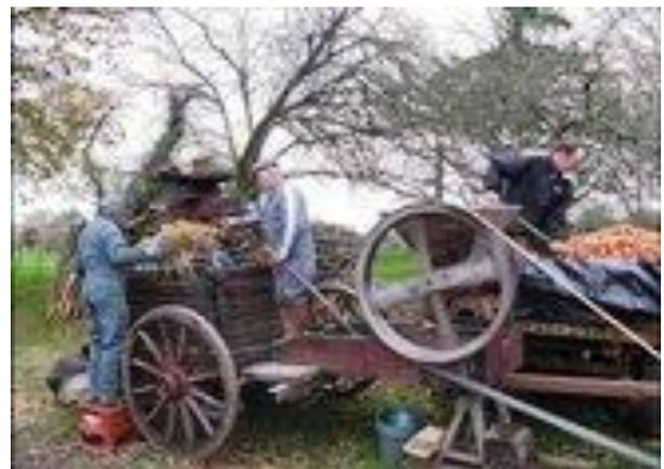
*Scène de fabrication de cidre ambulante. A droite, l'homme à l'aide d'une large pelle dépose les pommes dans le broyeur entraîné par une courroie rattachée à un moteur, tandis que les deux autres commencent la motte dans le pressoir. Reconstitution récente, mais le matériel est ancien.*
