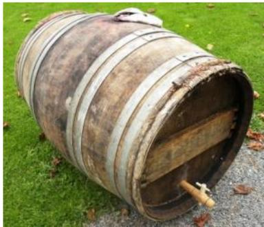
La chantepleure (du nom de chanter et pleurer qui évoque le liquide qui coule) est un robinet monté sur un cylindre de bois aminci à une extrémité. Quand on enfonce ce dernier dans l'orifice prévu sur l'un des fonds, « on perce la barrique ».
