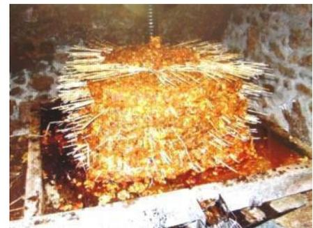
Ici, image d'une motte montée, sur un autre type de pressoir avec une vis au centre de la table, appelé Pressoir à vis.
